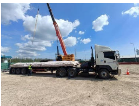
ภาพที่ 2.2-2 การปิดคลุมผ้าใบรถขนส่งวัสดุ
